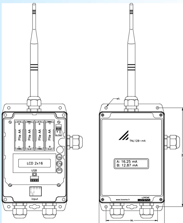
Une fois le couvercle retiré, on accède aux piles, boutons, afficheur LCD et connecteur Jack RS232.
